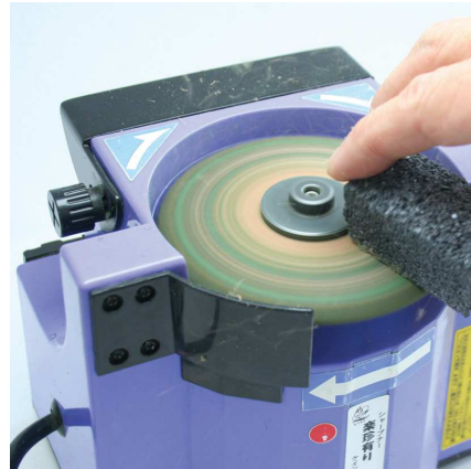
②面直しストーンを 皮バフに押し当てます
