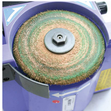
④皮バフ表面が画像 の様に毛羽たけば OK 最後に補助研磨剤を塗布
